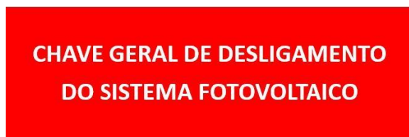
Figura 1 – Sinalização da chave geral de desligamento do sistema fotovoltaico
